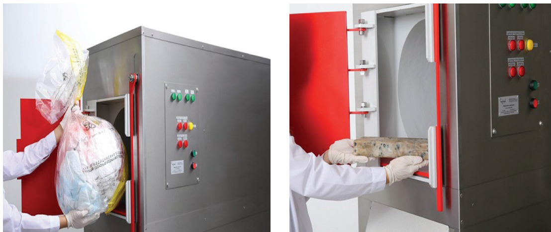
Рис. 2. Установка аппаратного обеззараживания и деструкции медицинских отходов
