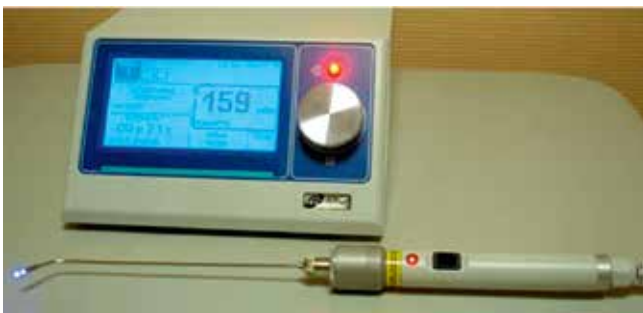
Рис. 1. Низкоинтенсивный светодиодный излучатель с рабочей длиной волны 405 нм с подключенной насадкой для проникновения в искусственное/расширенное соустье верхнечелюстной пазухи
